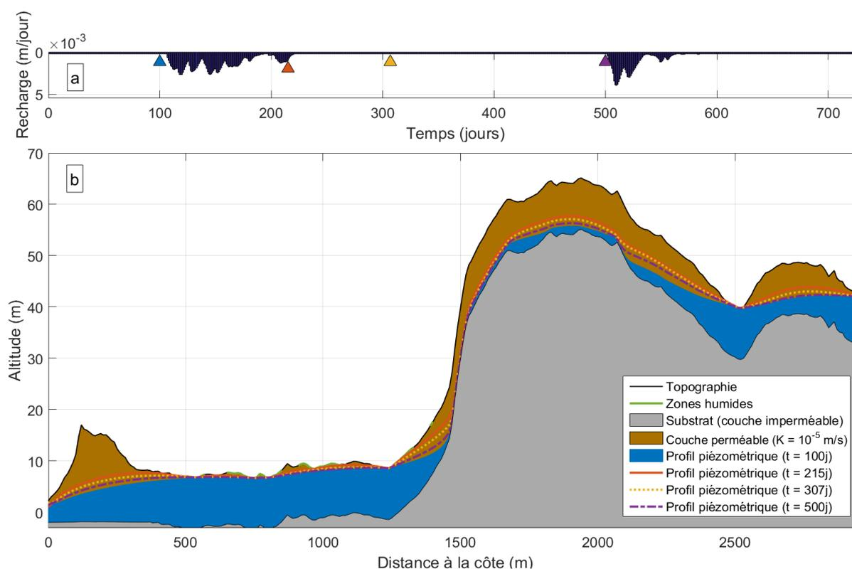
Figure 19 - Modèle du site de Bréville-sur-Mer avec une aquifère de perméabilité homogène  $K=10^{-5}$  m/s prenant en compte la paléofalaise. a. Représentation de la recharge appliquée au modèle sur 2 ans (730 jours). b. Représentation de 4 profils piézométriques à différents temps (100, 215, 307 et 500 jours).
