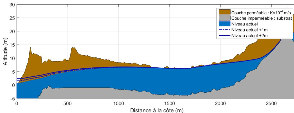
Figure 31 – Profils piézométriques modélisés pour le site de Coudeville-Plage pour un **marais arrière-littoral non mis en charge par la mer**, pour un aquifère de perméabilité homogène  $K=10^{-4} \text{ m.s}^{-1}$ , une recharge de 180mm/an et trois niveaux marins moyens : actuel, actuel + 1m, actuel + 2m.
