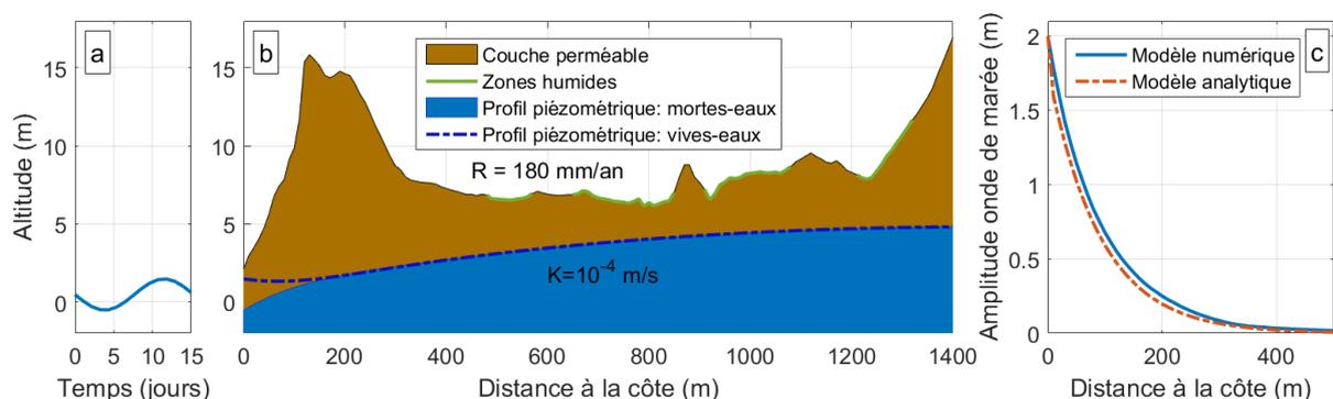
Figure 8 – a. Représentation du signal de marée correspondant à la composante semi-mensuelle ( $A=1\text{m}$  et  $T=15\text{j}$ ). b. Représentation des profils piézométriques en période de vives eaux et mortes eaux dans l'aquifère de Bréville-sur-Mer pour une perméabilité homogène  $K=10^{-4}\text{ m.s}^{-1}$ . c. Comparaison entre le modèle numérique et le modèle analytique. Les précipitations correspondent à la moyenne des précipitations sur cinquante ans.
