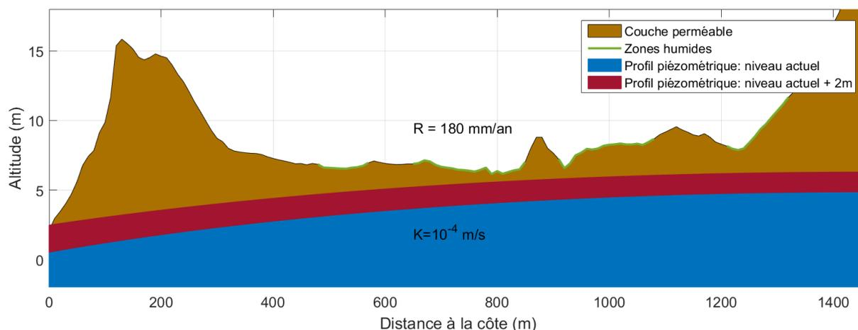
Figure 13 – Représentation des profils piézométriques du niveau moyen marin actuel et avec une augmentation de 2m dans l’aquifère de Bréville-sur-Mer pour une perméabilité homogène  $K=10^{-4} \text{ m.s}^{-1}$ .
