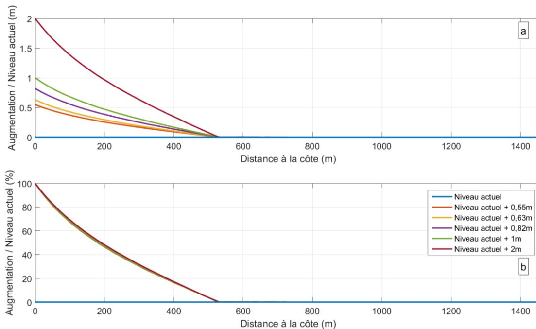
Figure 16 - a. Evolution du profil piézométrique (en m) par rapport au niveau moyen. b. Evolution du profil piézométrique (en %) par rapport au niveau moyen (100% étant l'augmentation du niveau moyen de la mer).
