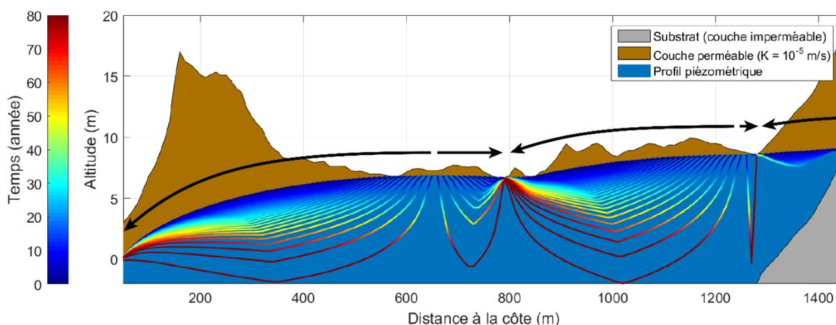
Figure 23 –Représentation des lignes d'écoulements (régime d'écoulement permanent) et temps de transit associés une recharge de 73 mm/an et une perméabilité d'aquifère  $K=10^{-5} \text{ m.s}^{-1}$ . Les flèches noires indiquent la direction des écoulements, mettant en évidence les zones d'exutoire (pointes des flèches) et les lignes de crêtes hydrologiques (origine des flèches) des écoulements.
