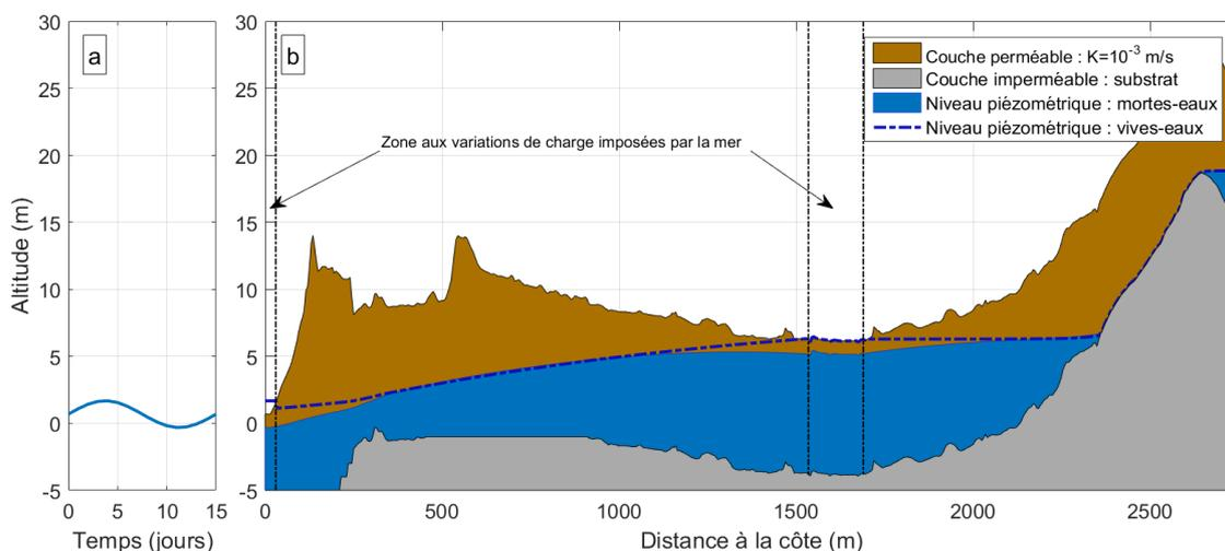
Figure 29 – a. Représentation du signal de marée correspondant à la composante semi-mensuelle ( $A=1\text{m}$  et  $T=15\text{j}$ ). b. Comparaison des profils piézométriques modélisés pour le site de Coudeville-Plage en période de vives eaux et mortes eaux pour un marais arrière-littoral mis en charge par la mer, pour un aquifère de perméabilité homogène  $K=10^{-3} \text{ m.s}^{-1}$ , une recharge de 180mm/an et le niveau marin moyen actuel.
