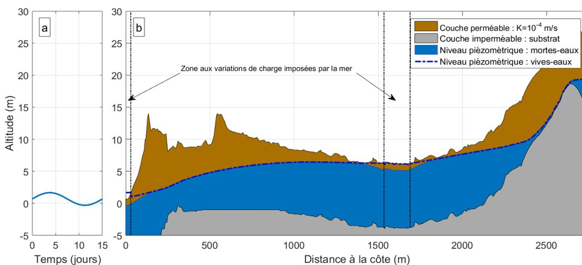
Figure 30 - a. Représentation du signal de marée correspondant à la composante semi-mensuelle ( $A=1\text{m}$  et  $T=15\text{j}$ ). b. Comparaison des profils piézométriques modélisés pour le site de Coudeville-Plage en période de vives eaux et mortes eaux pour un marais arrière-littoral mis en charge par la mer, pour un aquifère de perméabilité homogène  $K=10^{-4} \text{ m.s}^{-1}$ , une recharge de 180mm/an et le niveau marin moyen actuel.
