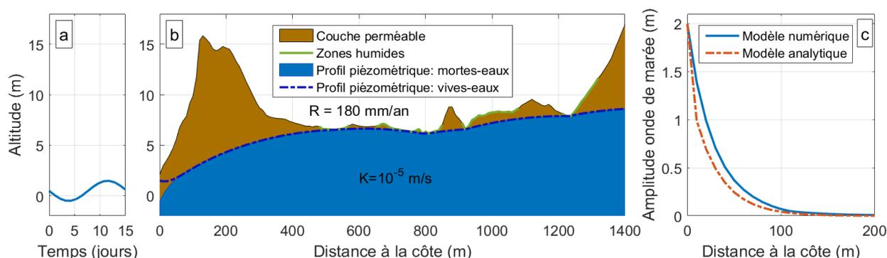
Figure 9 – a. Représentation du signal de marée correspondant à la composante semi-mensuelle ( $A=1\text{m}$  et  $T=15\text{j}$ ). b. Représentation des profils piézométriques en période de vives eaux et mortes eaux dans l'aquifère de Bréville-sur-Mer pour une perméabilité homogène  $K=10^{-5}\text{ m.s}^{-1}$ . c. Comparaison entre le modèle numérique et le modèle analytique. Les précipitations correspondent à la moyenne des précipitations sur cinquante ans.
