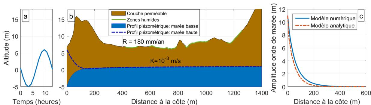
Figure 11 - a. Représentation du signal de marée correspondant à la composante journalière ( $A=5.5\text{m}$  et  $T=12\text{h}$ ). b. Représentation des profils piézométriques en période de vives eaux et mortes eaux dans l'aquifère de Bréville-sur-Mer pour une perméabilité homogène  $K=10^{-3} \text{ m.s}^{-1}$ . Les précipitations correspondent à la moyenne des précipitations sur cinquante ans.
