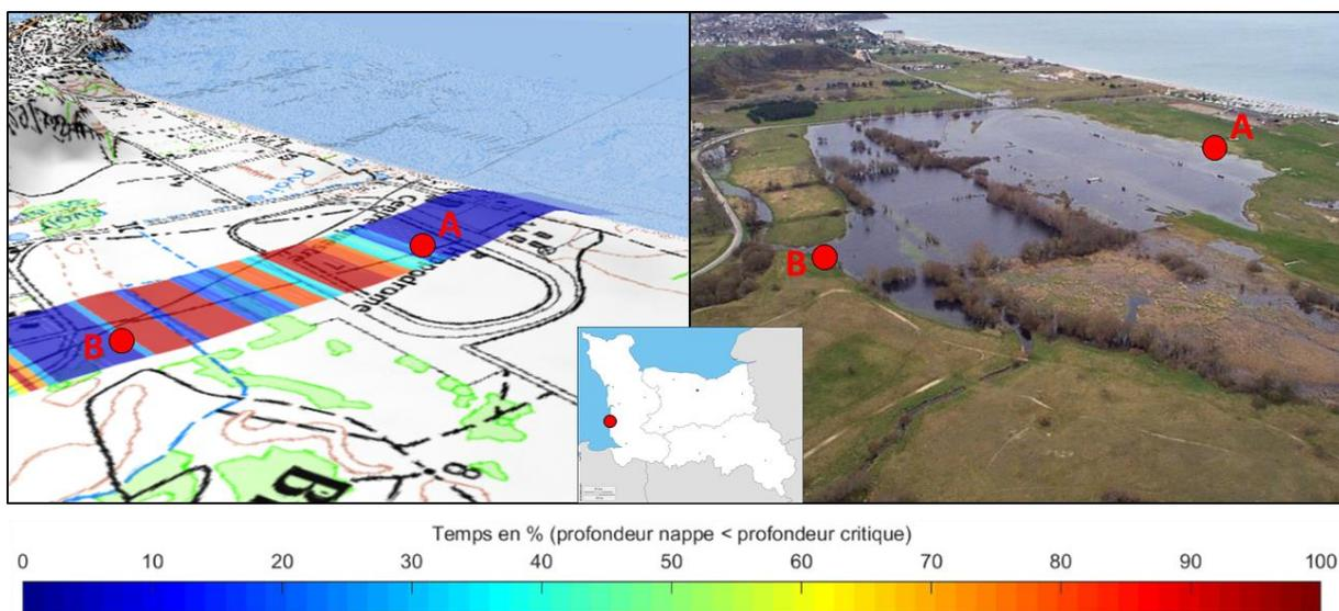
Figure 22 – Droite : projection des résultats du modèle du site de Bréville-sur-Mer sur la carte IGN associée, exprimés en durée de saturation des sols (données de la Figure 21). Gauche : Photographie aérienne de l'inondation de 2001 sur le site de Bréville-sur-Mer. Des repères spatiaux entre les deux figures sont matérialisés par les points A et B.
