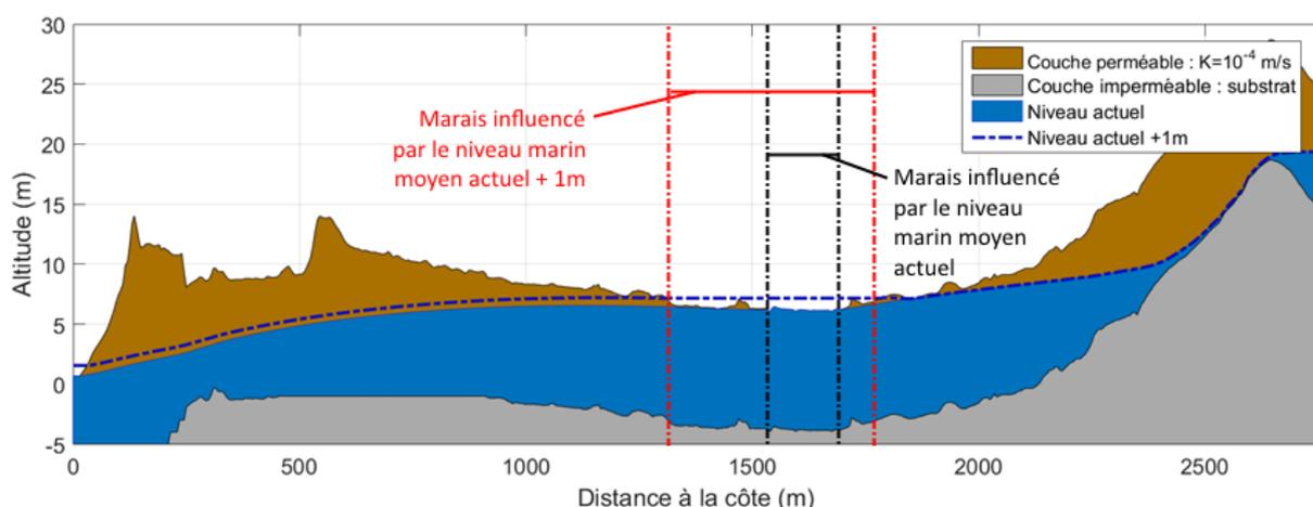
Figure 32 – Profils piézométriques modélisés pour le site de Coudeville-Plage pour un **marais arrière-littoral mis en charge par la mer**, pour un aquifère de perméabilité homogène  $K=10^{-4} \text{ m.s}^{-1}$ , une recharge de 180mm/an et deux niveaux marins moyens : actuel et actuel + 1m.
