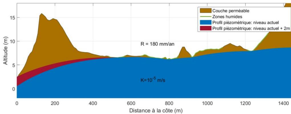
Figure 15 - Représentation des profils piézométriques du niveau moyen marin actuel et avec une augmentation de 2m dans l'aquifère de Bréville-sur-Mer pour une perméabilité homogène  $K=10^{-5} \text{ m.s}^{-1}$ .
