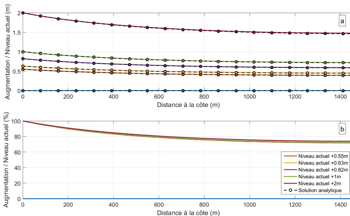
Figure 14 - a. Profils piézométriques modélisés (modèles numérique et analytique) pour le site de Bréville-sur-Mer, pour différents scénarios d’augmentation du niveau marin moyen. b. Augmentation modélisée de la hauteur du toit de nappe normalisée par l’augmentation du niveau marin moyen (100% étant l’augmentation du niveau moyen de la mer).
