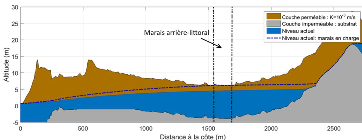
Figure 27 - Comparaison des profils piézométriques modélisés pour le site de Coudeville-Plage pour un marais arrière-littoral mis en charge ou non par la mer, pour un aquifère de perméabilité homogène  $K=10^{-3} \text{ m.s}^{-1}$ , une recharge de 180mm/an et le niveau marin moyen actuel. La charge hydraulique dans le marais lorsque le marais est en charge est imposée égale à la topographie. Le signal de marée n'est pas pris en compte.
