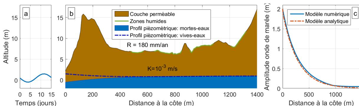
Figure 7 – a. Représentation du signal de marée correspondant à la composante semi-mensuelle ( $A=1\text{m}$  et  $T=15\text{j}$ ). b. Représentation des profils piézométriques en période de vives eaux et mortes eaux dans l'aquifère de Bréville-sur-Mer pour une perméabilité homogène  $K=10^{-3}\text{ m}\cdot\text{s}^{-1}$ . c. Comparaison entre le modèle numérique et le modèle analytique. Les précipitations correspondent à la moyenne des précipitations sur cinquante ans.
