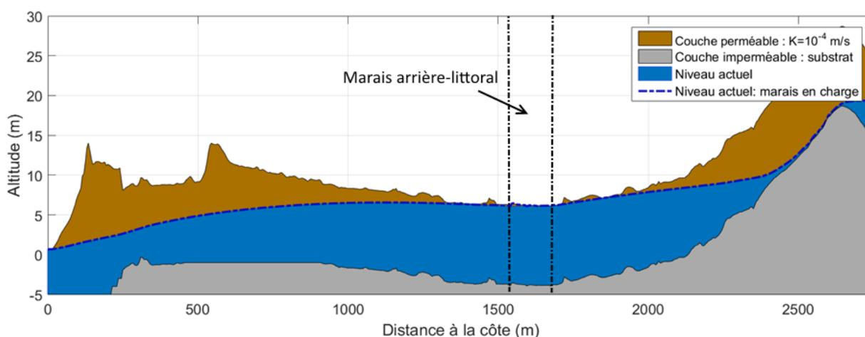
Figure 28 – Comparaison des profils piézométriques modélisés pour le site de Coudeville-Plage pour un marais arrière-littoral mis en charge ou non par la mer, pour un aquifère de perméabilité homogène  $K=10^{-4} \text{ m.s}^{-1}$ , une recharge de 180mm/an et le niveau marin moyen actuel. La charge hydraulique dans le marais lorsque le marais est en charge est imposée égale à la topographie. Le signal de marée n'est pas pris en compte.
