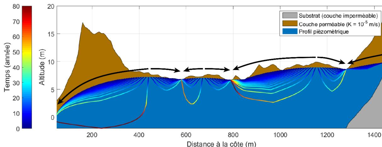
Figure 24 - Représentation des lignes d'écoulements (régime d'écoulement permanent) et temps de transit associés une recharge de 180 mm/an et une perméabilité d'aquifère  $K=10^{-5} \text{ m.s}^{-1}$ . Les flèches noires indiquent la direction des écoulements, mettant en évidence les zones d'exutoire (pointes des flèches) et les lignes de crêtes hydrologiques (origine des flèches) des écoulements.
