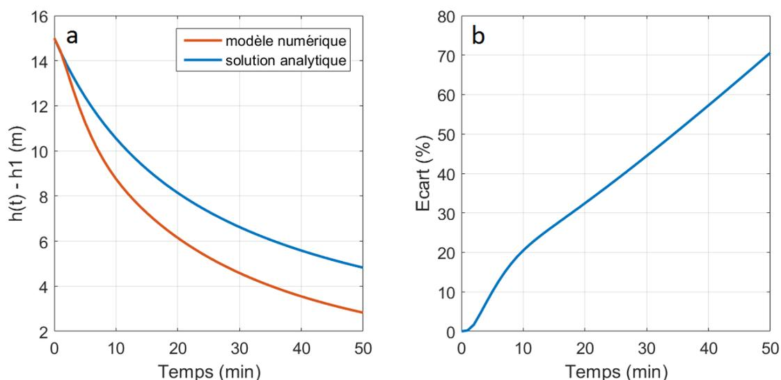
Figure 18 – a. Représentation du modèle numérique et de l'approximation analytique de la vidange d'une dune. b. Représentation de l'écart (en %) entre le modèle numérique et l'approximation analytique.
